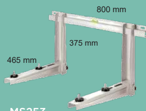
MS253 Bulle de niveau intégrée Charge max 140 kg
